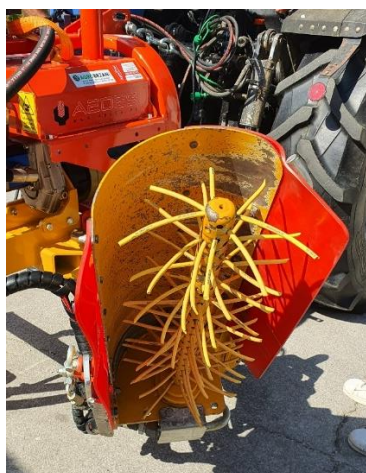
Slika1: V poskusu porabljen nitkar Slika 2: Nežnejše nitke novejšega modela nitkarja
